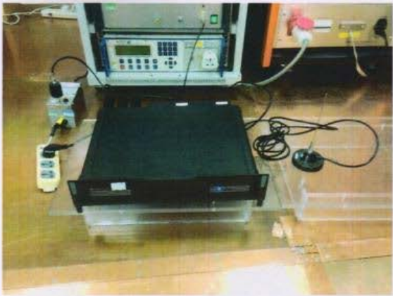
图十一：射频场感应（电源端口）的传导骚扰抗扰度检测布置图
