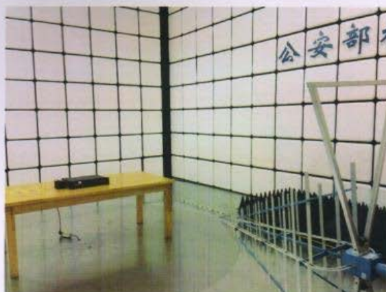
图十七：辐射骚扰检测布置图（30MHz-1000MHz）
