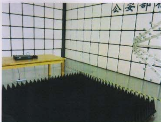
图五：射频电磁场辐射抗扰度检测布置图
